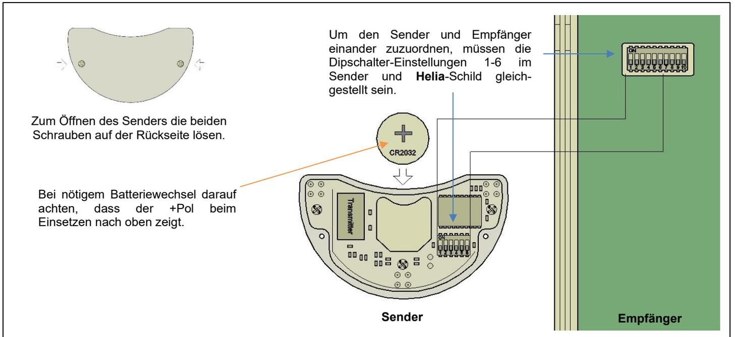
Sender und die Empfänger-Stuereinheit sind im Auslieferungszustand (DIP 1 bis 6) immer auf die Dip-Schalterposition 1 eingestellt. Falls mehrere Sender mit dem Signalschild kommunizieren sollen, müssen diese vor Ort gedippt werden. Die Dipschalter 7 bis 10 der Empfänger Steuereinheit beinhalten verschiedene Funktionen. Diese sind in der folgenden Tabelle aufgeführt.
